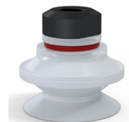
Variantenreferenz: 91 31SLT 18D-2-GIC • Farbe: Transluzent (Lebensmittels zertifikat) • Materiale: Silikon • Shore-Härte: SH60
