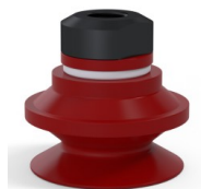
Variantenreferenz: 91 31SL 18D-2-GIC • Farbe: Rot (Lebensmittels zertifikat) • Materiale: Silikon • Shore-Härte: SH60
