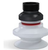
Variantenreferenz: 91 31SLT 38D-2 • Farbe: Transluzent (Lebensmittels zertifikat) • Materiale: Silikon • Shore-Härte: SH60
