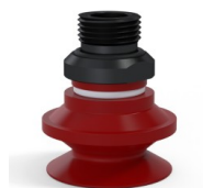
Variantenreferenz: 91 31SL 38D-2-GIC • Farbe: Rot (Lebensmittels zertifikat) • Materiale: Silikon • Shore-Härte: SH60
