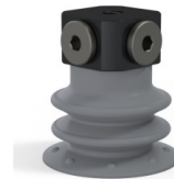
Variantenreferenz: 96 25NR FM5BD • Farbe: Grau • Materiale: Naturkautschuk • Shore-Härte: SH50
