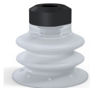
Variantenreferenz: 96 35SLT 18D-2-F • Farbe: Transluzent (Lebensmittels zertifikat) • Materiale: Silikon • Shore-Härte: SH60
