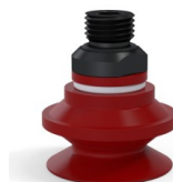
Référence déclinaison : 91 31SL 14D-2-F • Couleur: Rouge certification alimentaire CE • Dureté Shore: SH60 • Matière: Silicone
